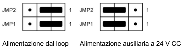
Figura 2: Configurazione ponticelli alimentazione
